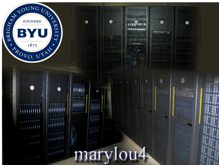
Σχήμα 8.1: Η συστοιχία τύπου Beowulf, Marylou4. Στην 66 η θέση της λίστας top500, αποτελεί το ισχυρότερο σύστημα Beowulf με gigabit ethernet δικτύωση, τον Νοέμβριο 2005.
